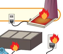
地震火災の原因の多くは電気が関連しており、電気機器など(電気ストーブ、電気コンロなど)の転倒による出火や、電気復旧時における通電火災(破損した電気コードのショートによる出火など)があります。このような電気火災を防ぐため、感震ブレーカーなどを設置しましょう。
